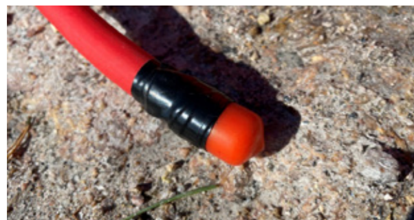
Endehylse tapet 4- 5 runder rundt detonerende lunte.
