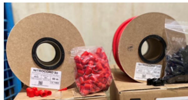
Endehylser med forskjellige diameter tilpasset det. lunte 80 og 100 g/m.
